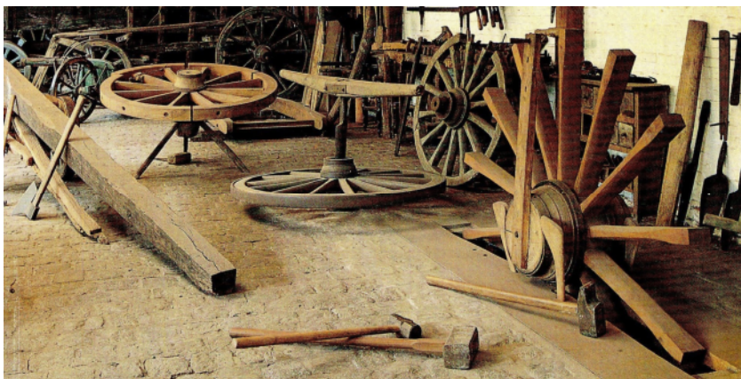
Fig. 7 - Het maken van een wiel. Achteraan links zien we hoe een wiel in elkaar wordt gepast op een driepikkel. Centraal ligt een wiel met schoeper. Vooraan rechts zien we een groot wiel in opbouw in een wielput. (L. DEVLIEGHER, Landelijk en ambachtelijk leven , Provinciaal Museum Bulskampveld. Beernem, Provincie West-Vlaanderen, 1992)
